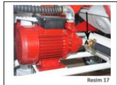
**Внимание! При первом подключении насоса к баку его нужно запустить, вручную заполнив всасывающую трубу.**
