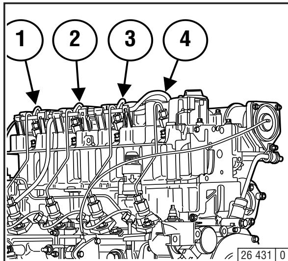
Цилиндры пронумерованы последовательно, начиная со стороны маховика.
